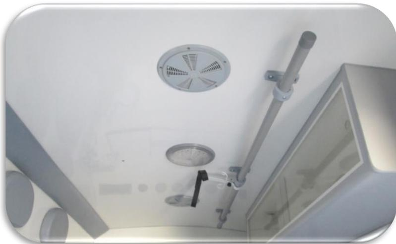
Teto do veículo composto, 01 (uma) luminária em Led, conjunto de ventilador/exaustor, balaústre em tubo encapsulado e armário construído em MDF, com acabamento na cor cinza.
