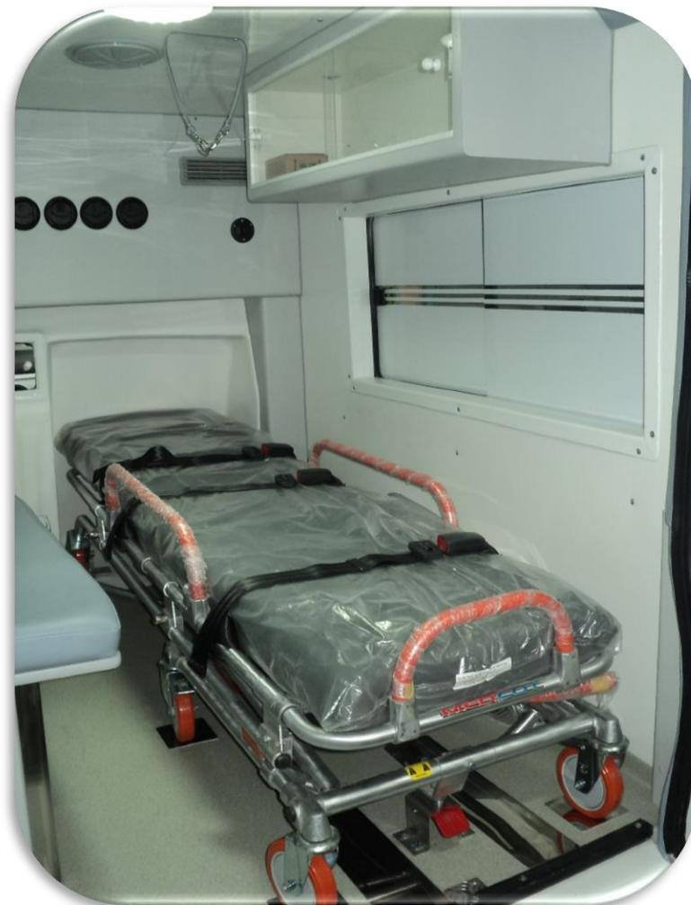
Revestimento interno em placas de fibra de vidro lisa, na cor branca, Isolamento térmico, acústico em placas de isopor, acabamento dos batentes em espuma, courvim automotivo e maca retrátil com estrutura tubular em alumínio .
