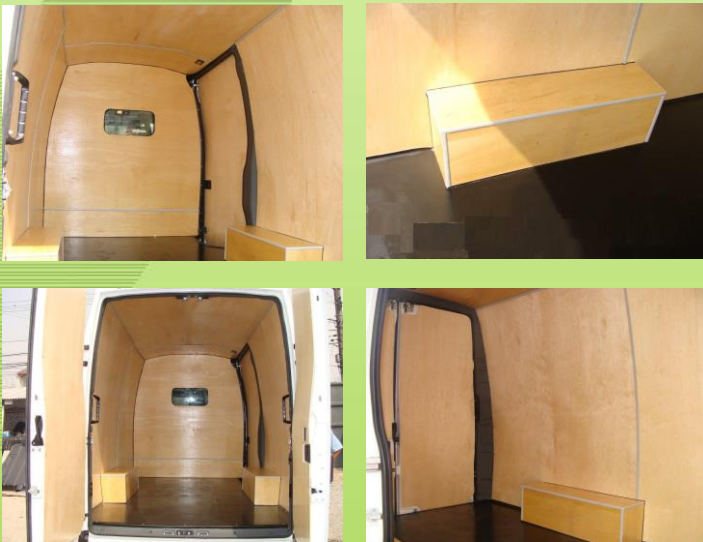
Revestimento de proteção
